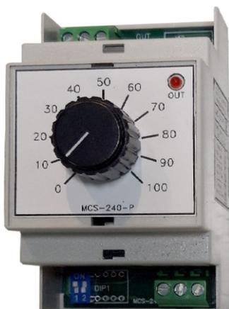
Questo modulo viene utilizzato per generare segnali di controllo SSR con tempi proporzionali adatti a comandare i relè statici zero-crossing. Controllo tramite potenziometro fronte pannello. I tempi sono programmabili tramite dip-switch.
