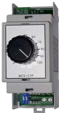
Questo modulo viene utilizzato per generare segnali di controllo SSR con tempi proporzionali adatti a comandare i relè statici zero-crossing. Controllo tramite potenziometro fronte pannello. I tempi sono programmabili tramite dip-switch.
